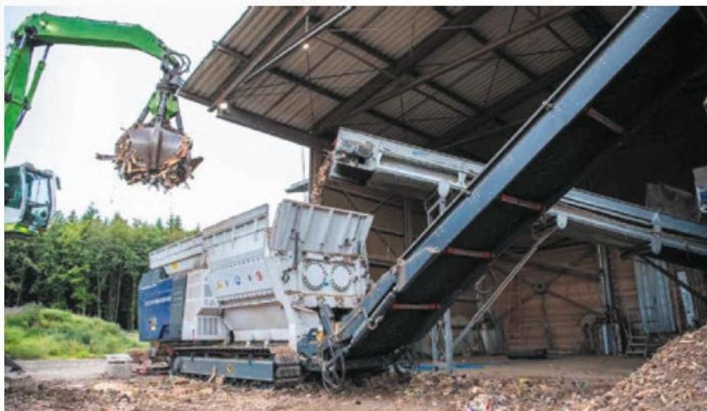
levando il nastro dalla pala gommata durante la triturazione. Per materiali particolarmente pesanti, come rottami leggeri e rifiuti commerciali difficili, il nastro trasportatore può essere rinforzato con acciaio.
