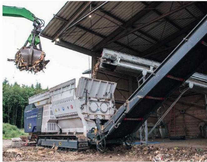
L'altezza del nastro trasportatore può essere facilmente regolata durante il funzionamento, semplicemente sollevando il nastro dalla pala gommata durante la triturazione. Per materiali particolarmente pesanti, come rottami leggeri e rifiuti
