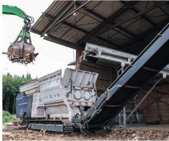
completamente ripiegato. L'altezza del nastro trasportatore può essere facilmente regolata durante il funzionamento, semplicemente sollevando il nastro dalla pala gommata durante la triturazione. Per materiali particolarmente
