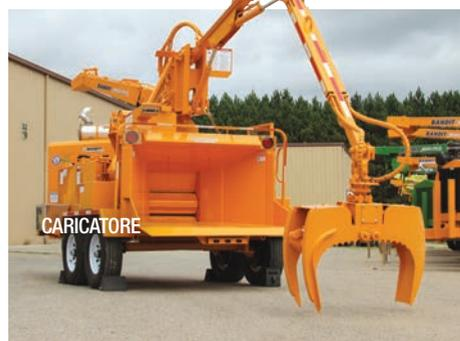
I sottocarri cingolati semoventi sono estremamente diffusi, consentendo agli operatori di portare la cippatrice direttamente sul luogo di lavoro. Sulle cippatrici più grandi, i sistemi di caricamento integrati aiutano a caricare materiale di grandi dimensioni senza la necessità di attrezzature aggiuntive.
