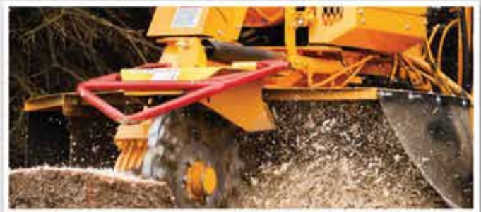
ZONA DI CONTENIMENTO DEI TRUCIOLI
