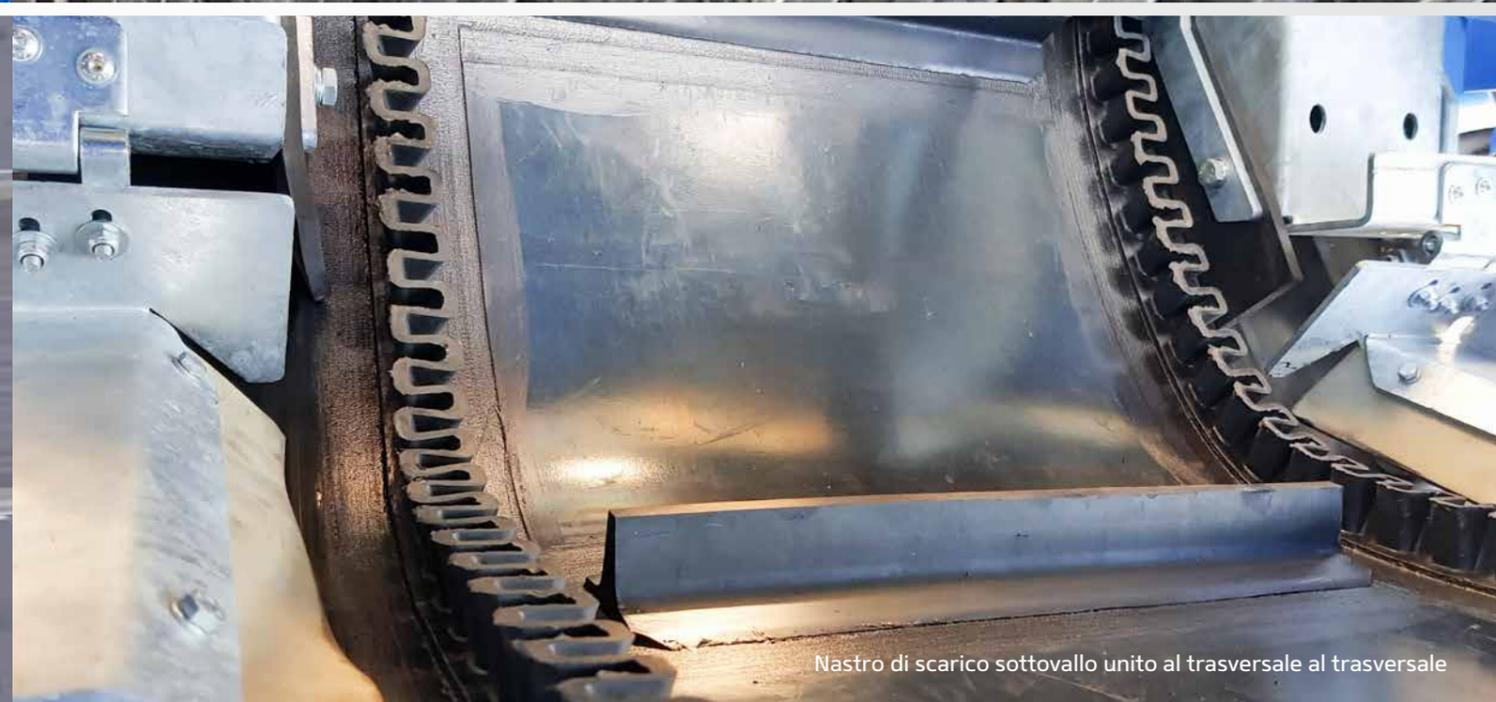
Nastro di scarico sottovallo unito al trasversale al trasversale
