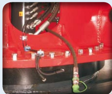
Serbatoio olio idraulico e riduttore di rotazione con innesti rapidi per rendere più rapide e agevolare le operazioni di cambi olio, senza rischi di spargimento liquidi.
