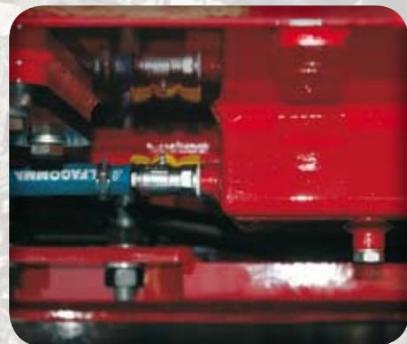
**Rubinetto** di chiusura serbatoio gasolio per semplificare e velocizzare i lavori di manutenzione.
