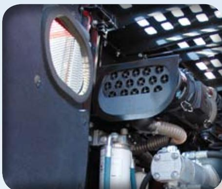
**Filtro aria** a micro-cicloni con sistema autopulente a depressione di serie: minori tempi e costi di manutenzione, maggiore efficacia del filtro aria, condizioni di lavoro ottimali per il motore diesel.
