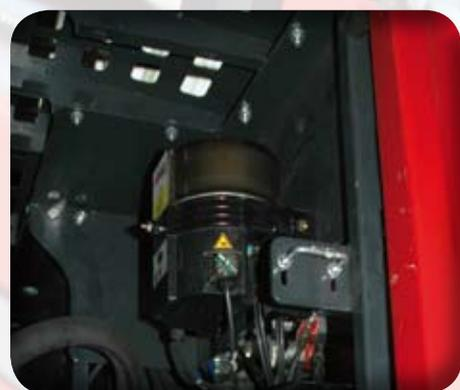
**Impianto di ingrassaggio centralizzato automatico di serie** per ralla e bracci.
